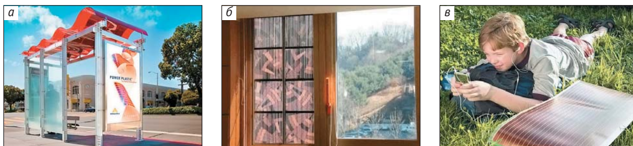
Рис.2. Возможные области применения органических солнечных батарей: в качестве полупрозрачной крыши остановок общественного транспорта (а), в энергоэффективных окнах (б) и для зарядки портативных электронных устройств (в).
