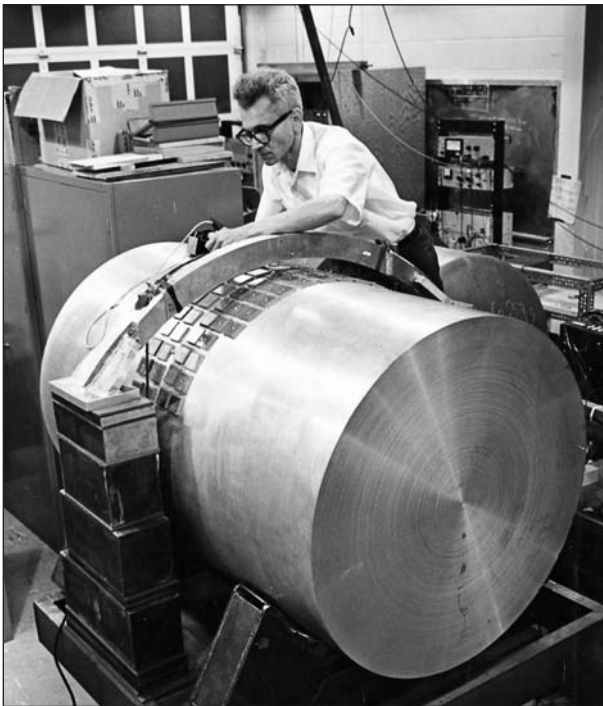
Рис.2. Джозеф Вебер с первым гравитационно-волновым детектором — твердотельным алюминиевым акустическим резонатором («болванкой» длиной 1.5 м, весом 1.2 т, с акустической частотой 1.6 кГц).
