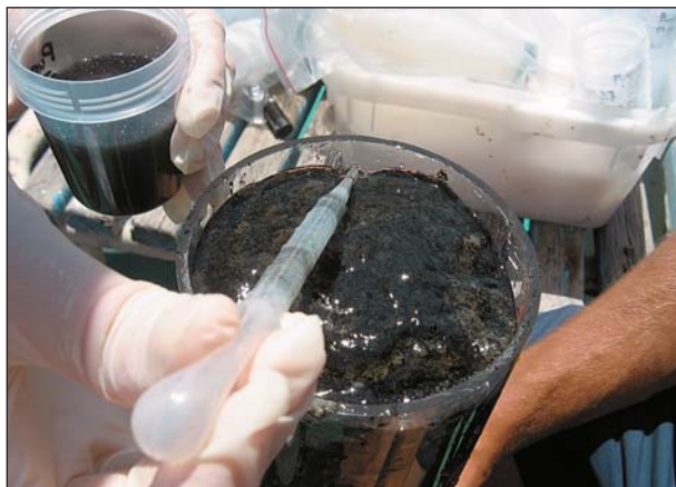
Рис.3. Отбор наилка из колонки мультикорера на борту судна.
